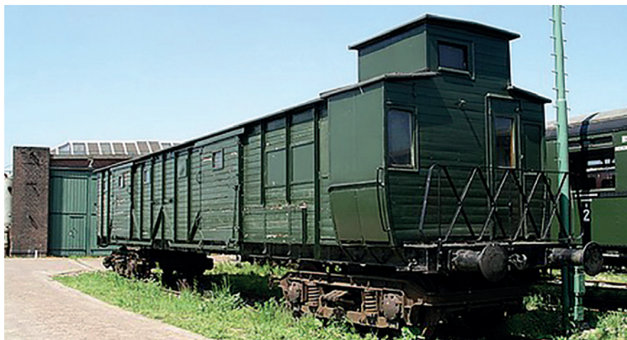
Bagagewagen met uitkijkpost voor de conducteur om de armseinen in de gaten te houden.
